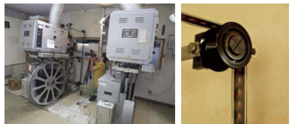
映写室では2台の映写機が毎日、稼働している。映画会社から送られてくるフィルムを張り合わせ、一本のフィルムにしてから上映する。
