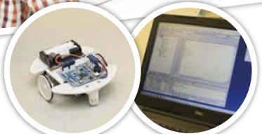
↑プログラミングの様子。パソコンに打ち込んだ命令は、翻訳されてロボットにダウンロードされ、動作する。
