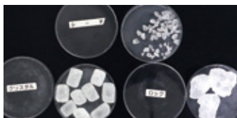
同じ氷砂糖のかげら「シード」から、自然結晶タイプの「ロック」と機械結晶タイプの「クリスタル」。それぞれの製造の違いを知ることができる。
