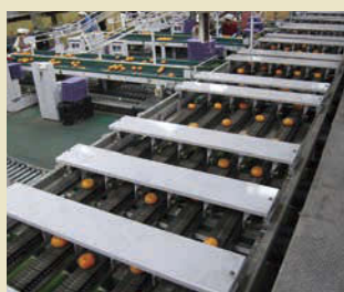
ベルトコンベアで流れてきた富有柿を、電子 カメラを備えた自動選果機がえり分ける。
