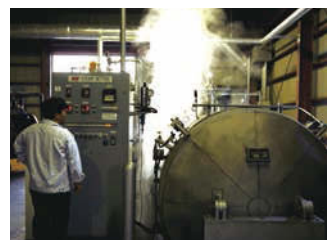
高速で複数の糸を燃る作業中。燃りをかけた糸にアイロンをかけ、まっすぐにする。
