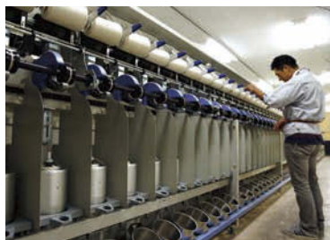
糸を燃って巻き取る機械「ダブルツイスター」。
